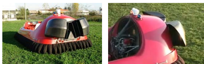
Les coquilles interceptent le flux de propulsion, agissant sur l'orientation du véhicule.
